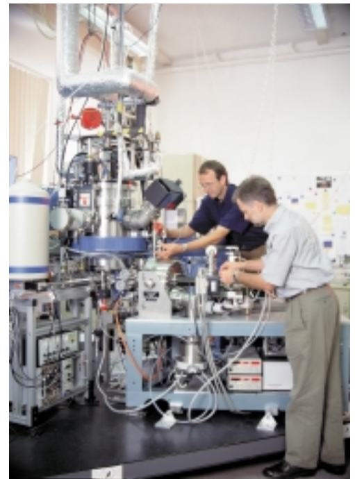
Mit der Ionenfalle EBIT werden hochgeladene Ionen erzeugt und untersucht
