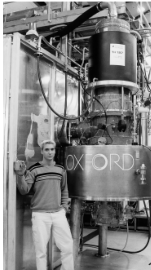
Das Prototyp-Gyrotron für WENDELSTEIN 7-X im Teststand in Karlsruhe
