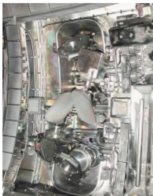
Schwenkbare Spiegelsystem im Plasmagefäß von ASDEX Upgrade zur Einkoppelung von Mikrowellen
