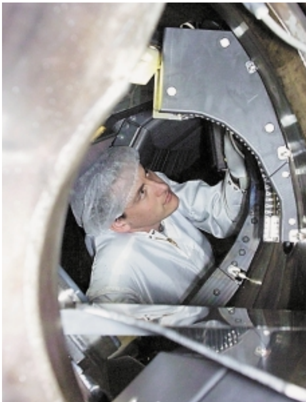
Einbau der Divertor-Module in das Vakuumgefäß von WENDELSTEIN 7-AS
