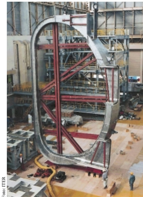
Prototyp der Hälfte eines Plasmagefäß- Sektors in Originalgröße - nach dem ITER-Entwurf von 1998 - hergestellt in Japan
