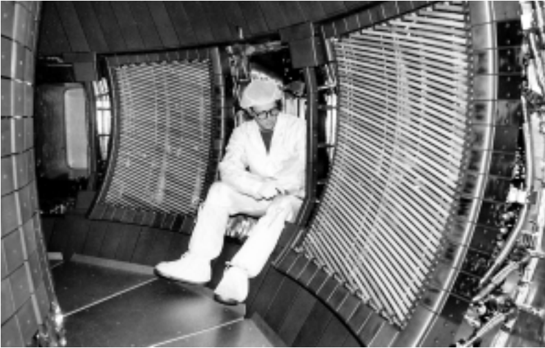
Blick auf zwei Antennen der Ionen-Zyklotron-Resonanzheizung im Plasmagefäß von ASDEX Upgrade
