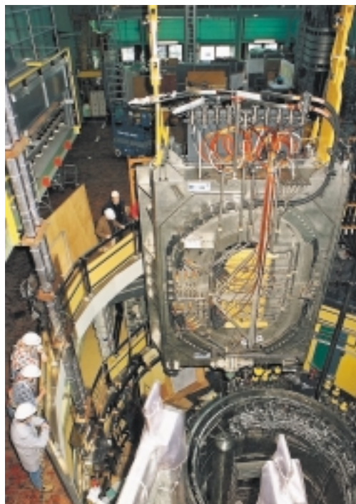
Test der supraleitenden ITER-Modellspule im Forschungszentrum Karlsruhe
